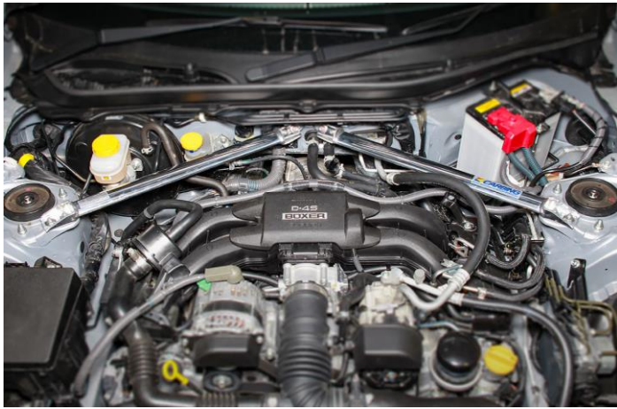
↑ トヨタ GR86, 86 /スバル BRZ フロント/アッパー/アルミ製
