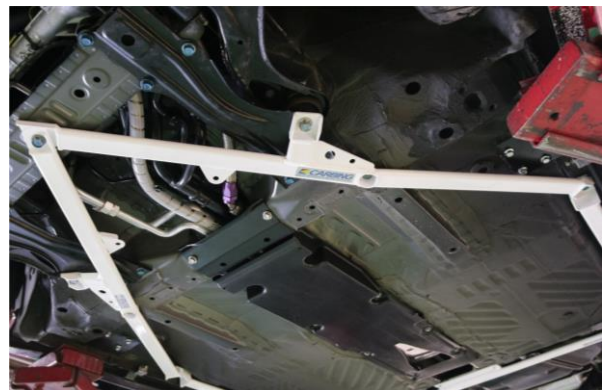
↑ トヨタ GR ヤリス(GXPA16) フレームブレース/フロント
