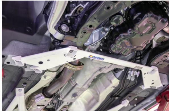
↑ トヨタ GR86, 86 /スバル BRZ フロント/アッパー/アルミ製
