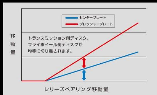
①プレッシャープレート/センタープレートを、ストラッププレート(板バネ)で接続。
