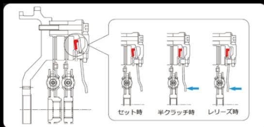
ピボットリング(低剛性スプリング)をプレッシャープレートとダイヤフラムスプリング間に設置。半クラッチ時は低剛性スプリング(ピボットリング)がクッションとなり半クラッチゾーンを拡大。メタルでありながらスムーズな発進性能を可能にしました。
