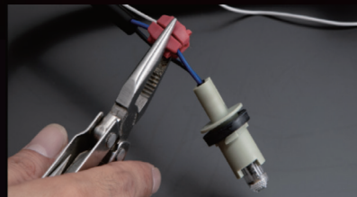
ポジション線へエレクトロタップ接続
