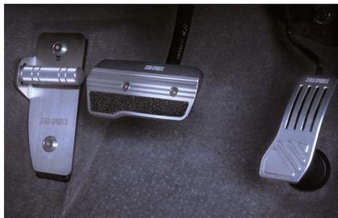
ブラケットのベースプレートには、質感の高いステンレス SUS304(ヘアライン加工)を採用。バーには、強度の高いジュラルミン A7075 を採用。グリップ力を高めるため切削ローレット加工を施し強い踏み込みにも対応。左足を置くバーの位置は、フットレストバーの取付位置またはバーの固定位置によりドライバーにあわせて調整が可能。
