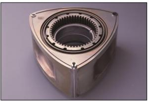
株式会社オートエクゼ(代表:寺田陽次郎)は、RX-7/RX-8 用「ファインチューニングリビルトエンジン」を新設定し、マツダ販売会社、有名カー用品店など、オートエクゼ商品取扱店などを通じて発売する。「ファインチューニングリビルトエンジン」は、高精度ハンドメイド生産によるフルオーバーホールを施した仕様。1/100mm 以下の寸法管理を徹底し、燃焼室内の気密性と回転バランスを追求。量産同等以上の耐久性を確保したうえで、ロータリーエンジンの美点である静粛性を備えたスムーズな回転フィールを実現する。
