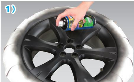
1) 1回目の塗装は、薄くムラなく塗装して下さい。塗料を吹き付ける時は、塗る面と噴射口の間を約15cm～30cmの間隔を取り、平行に移動しながら吹き付けて下さい。
