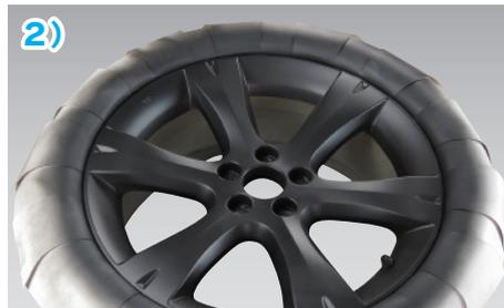
2) 1回目の塗装が乾燥したら、その後数回に分けて塗り重ねて行きます。2回目からは少し厚めに(垂れないように注意しながら)塗装して構いません。塗膜のゴムが同化しますので、お好みにより数回塗り重ねて下さい。なお、厚塗りするほど、剥がしやすくなります。
