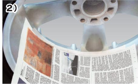
2) 周りに塗料が飛び散って汚れないように、ホイールの下に新聞紙などを広めて敷いて下さい。ホイール内側の塗装したくない部分を、新聞紙やマスキングシート・マスキングテープなどを使ってカバーして下さい。
